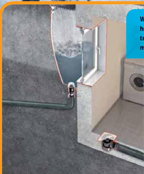
Kellerschutz durch hochwasserdichten Lichtschacht, hochwasserdichte Leibungsfenster und Rückstausicherung von ACO.
