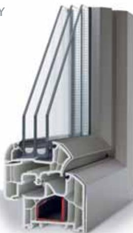
standhalter wird sogar eine Wärmedämmung bis  $U_w = 0,78 \text{ W/m}^2\text{K}$  erzielt. Fünf-Kammer-Profile, der Einsatz eines speziell ausgebildeten Versteifungseisens sowie drei umlaufende Dichtungsebenen sorgen für einen extrem günstigen Isothermenverlauf und eine perfekte Energie-
